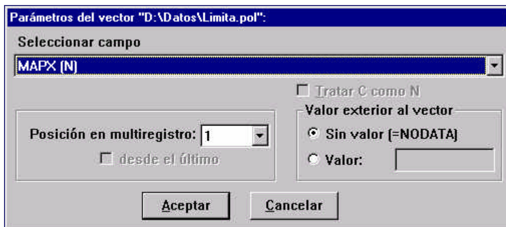
Figura 2.1 Imagen de la interfaz de configuración de los parámetros en la rasterización de un vector que forma parte de una fórmula matemático-lógica en la Calculadora/Reclasificadora de Capas.
